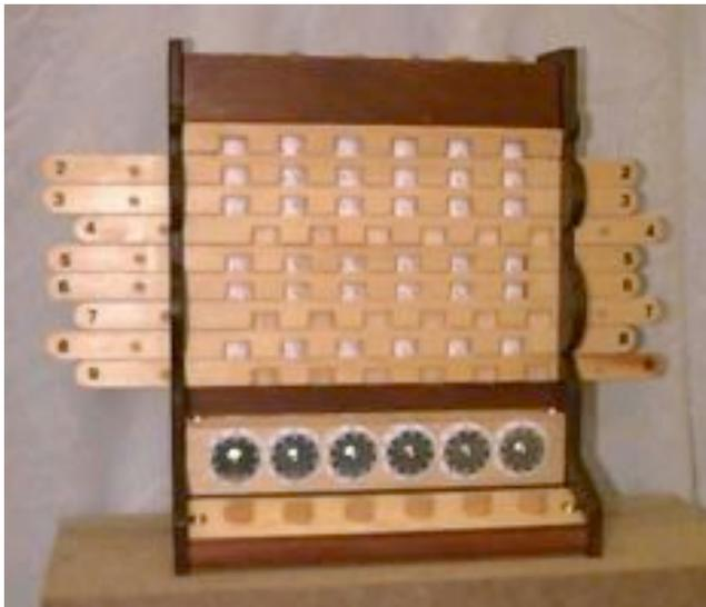
Fig. 1. Ricostruzione dell'Orologio Calcolatore di Schickard (Deutsches Museum, Monaco).
