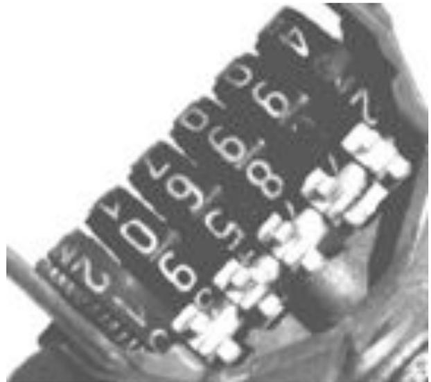
Contatore decimale di tipo meccanico (particolare di un contachilometri di un'automobile). [foto dell'autore]
