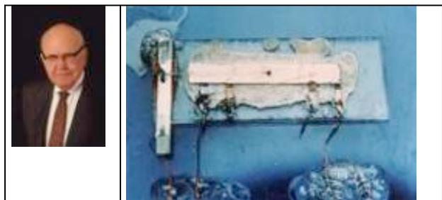
Nel 1958, l'ingegnere americano Jack C. Kilby della Texas Instruments aprì l'era della miniaturizzazione dei circuiti elettronici con l'invenzione del circuito integrato. Kilby riuscì a combinare diversi componenti elettronici (transistor, diodi,
