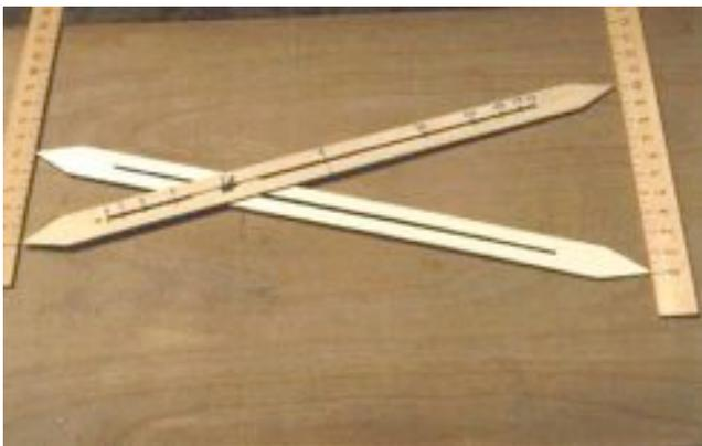
Fig. 1. Ricostruzione di un compasso di proporzione.
