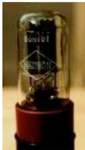
Una valvola dello stesso tipo (6SN7) di quelle utilizzate nell'ENIAC per la realizzazione dei flip-flop.
