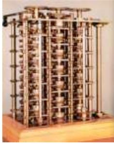
Una parte della macchina delle Differenze montata nel 1832.
