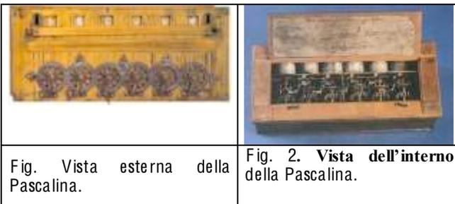
Quando la prima ruota (quella dell'unità) completa un giro, fa avanzare di un'unità quella contigua delle decine e così via. Poiché le ruote possono girare in una sola direzione non è possibile svolgere la sottrazione girando in senso opposto le ruote. La sottrazione viene invece ridotta ad una somma mediante un accorgimento basato sulla complementazione delle cifre del sottraendo (*complemento a nove*), tecnica già utilizzata con l'abaco.
