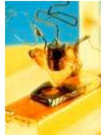
Il primo transistor realizzato nei laboratori della Bell.
