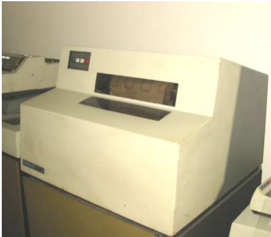
Fig. Stampante di linea di un computer (stampante a catena) Univac 90/30, 1975.
