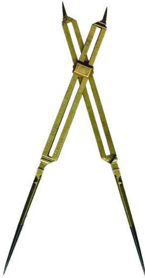
**Il compasso di proporzione (o compasso di riduzione) è costituito da una coppia di aste fissate a metà con delle cerniere, e con le punte su entrambe le estremità di ciascuna asta.**
