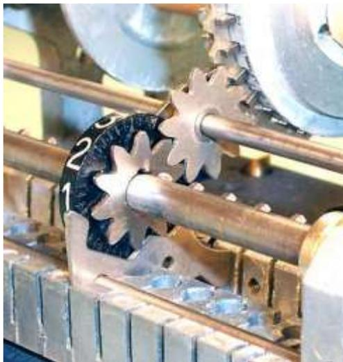
**In una ruota dentata, l'elemento costruttivo che rappresenta (memorizza) il numero è anche l'elemento calcolante.**
