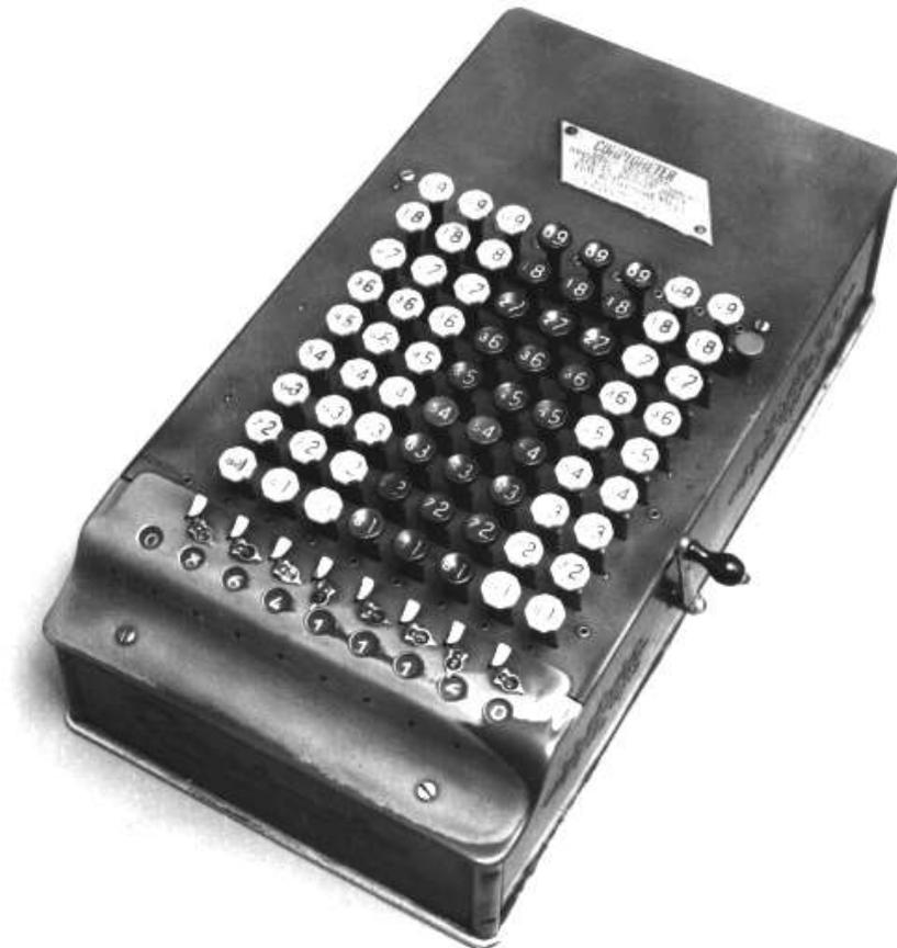
**Comptometer (ideato da Felt, nel 1884) una delle prime calcolatrici meccaniche per uso commerciale dotate di tastiera.**
