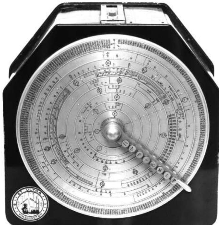
**Regolo calcolatore modello Washington per il calcolo del cemento armato.**
