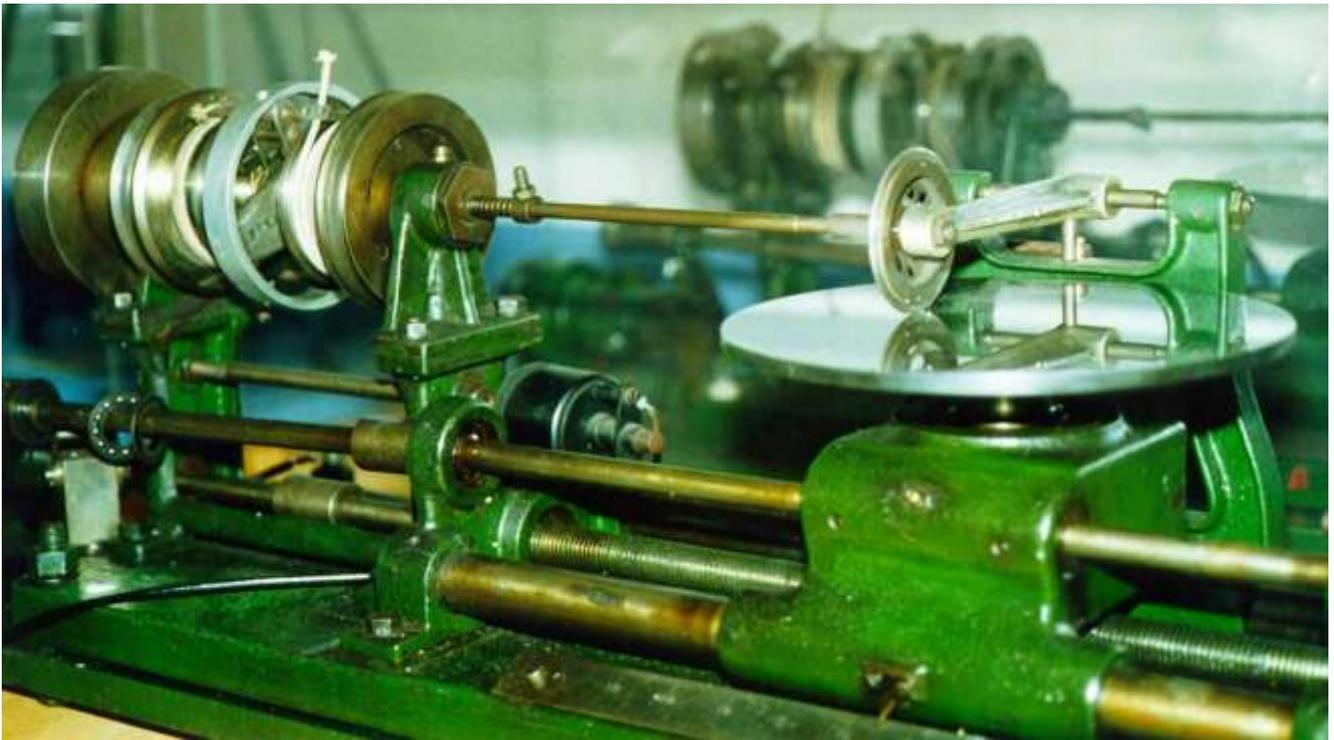
**Vista delle ruote e dischi di integrazione della macchina. I dispositivi che sembrano dei motori sulla sinistra sono gli “amplificatori di torsione di Nieman”, dispositivi a guida d’argano che funzionavano come amplificatori meccanici per poter procedere nelle successive operazioni di integrazione senza perdita di accuratezza.**
