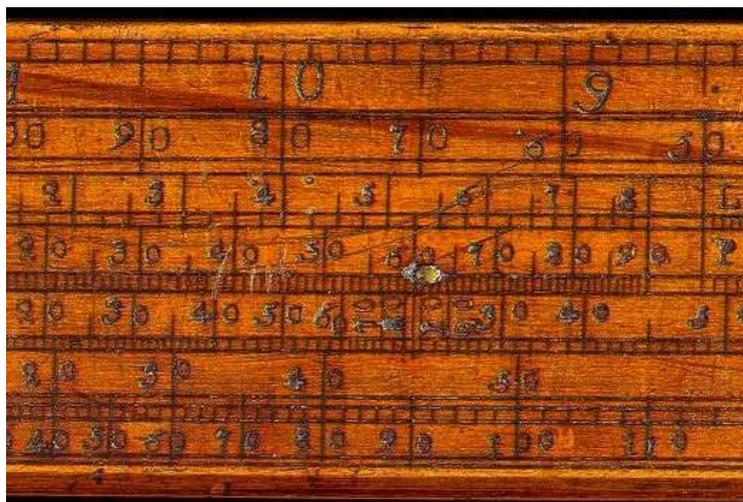
Il primo regolo calcolatore in grado di eseguire moltiplicazioni e divisioni fu proposto dall'inglese **Edmund Gunter** (1581-1626) attorno al 1620 ed era basato su un'unica scala logaritmica (detta *linea dei numeri di Gunter*) riportata sopra un regolo da utilizzare insieme ad un compasso (comparatore)
