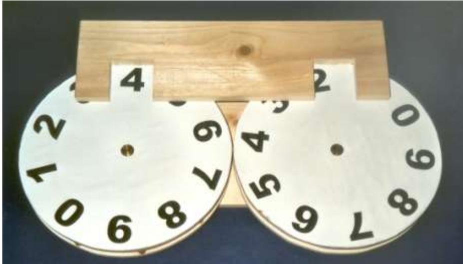
Ad esempio, per eseguire la somma  $2 + 5$ , si dovrà aggiungere 5 alla ruota con dieci denti che è già stata portata su 2; in concreto, ciò significa che la ruota verrà ruotata in avanti di cinque posizioni in modo che alla fine del movimento, la ruota mostri il numero 7, che è il risultato dell'operazione.
